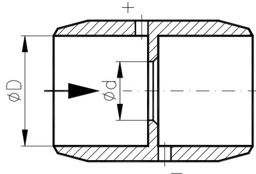
Auf Wunsch können auch Rohrenden, meist beigestellt, im Ein- und Auslauf angeschweißt werden. Hierbei wird die Schweißnaht nach der Schweißung innen bearbeitet, um die Forderungen des Berechnungsstandards an die Rohrbeschaffenheit zu gewährleisten.
