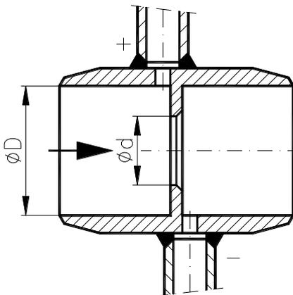
Ausführung Entnahme mit Ringkammer
